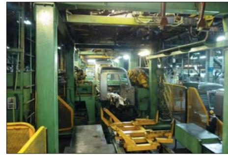
На участке общей сборки-сварки кабин обеспечена стабильная подача сжатого воздуха, добавлены подвески в систему ПТК, исключены задержки линии из-за дефектовки, изменены программы сварки, проводится постоянное обследование оборудования
