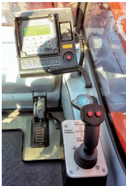
Управление при помощи рычагов ушло в далекое прошлое, их заменили кнопки и джойстик
