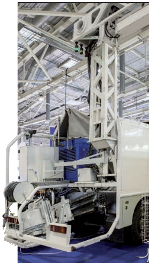
Излучатель бетатрона расположен в заднем свесе автомобиля за дизель-генератором
