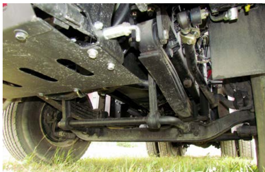
Допустимая нагрузка на переднюю ось увеличена с 7,5 до 9 т
