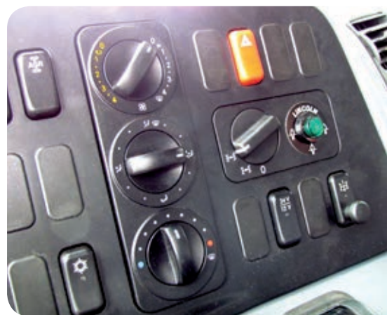
На панели приборов – переключатель на приведение в действие механизма блокировки межосевого и межколесных дифференциалов
