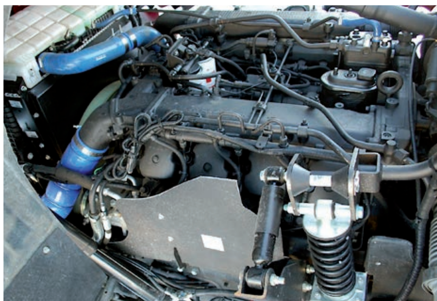
На самосвале установлен 400-сильный двигатель V8 КАМАЗ-740.63 (Euro 4)
