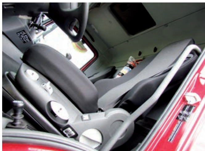
Пневмоподдрессоренное водительское сиденье Grammer с широким диапазоном всевозможных регулировок
