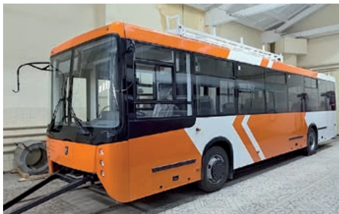
Первый кузов НЕФАЗ для изготовления троллейбуса
