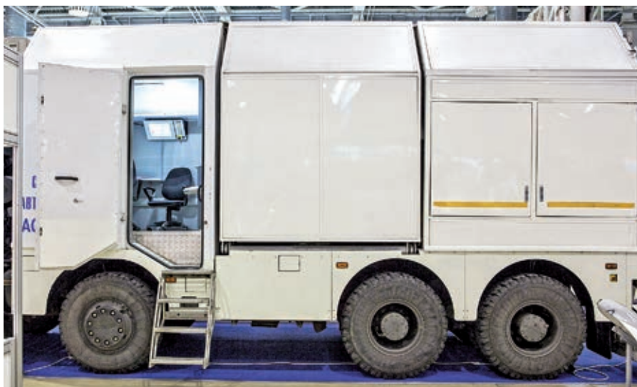
За пультовым модулем размещен отсек для корзины с передвижной установкой зондирования мечеными нейтронами, а следом за ним шкаф блока питания
