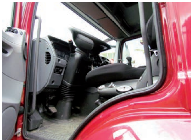
Поручни справа и слева, регулируемый руль делают посадку в кабину беспрепятственной
